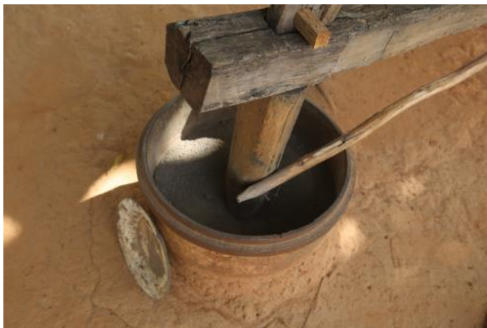
Figura 27: Barro triturado na gangorra, comunidade Campo Alegre, Turmalina. Fonte: Acervo Iepha/MG
