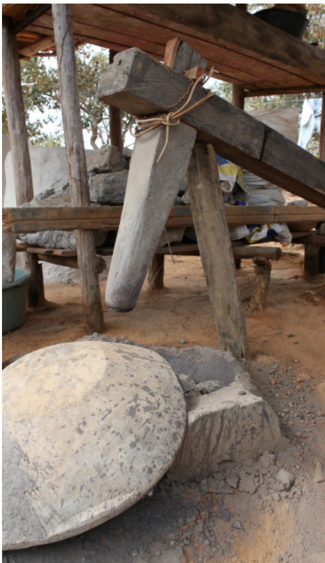
Fig. 10: Gangorra para socar o barro, comunidade Cachoeira do Fanado - Minas Novas - Acervo: Iepha/MG
