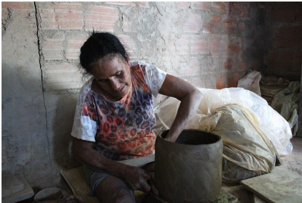
Figura 30: A artesã Adília da Silva levantando um filtro por meio do repuxo - comunidade de Pasmadinho, Itinga. Fonte: Acervo Iepha/MG
