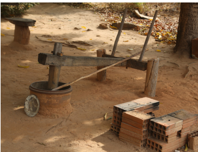
Fig. 14: Gangorra de socar barro, comunidade Campo Alegre - Turmalina - Acervo: Iepha/MG
