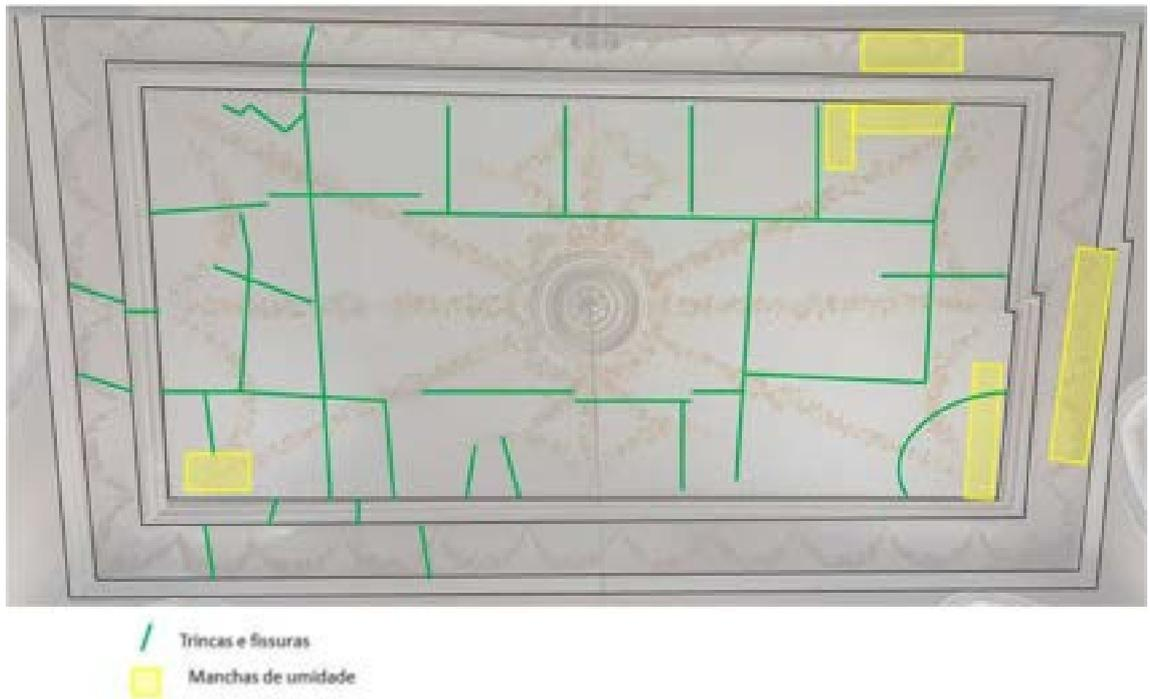
**Figura 47:** Forro lado da Epístola. Mapeamento das trincas, fissuras e manchas de umidade.
