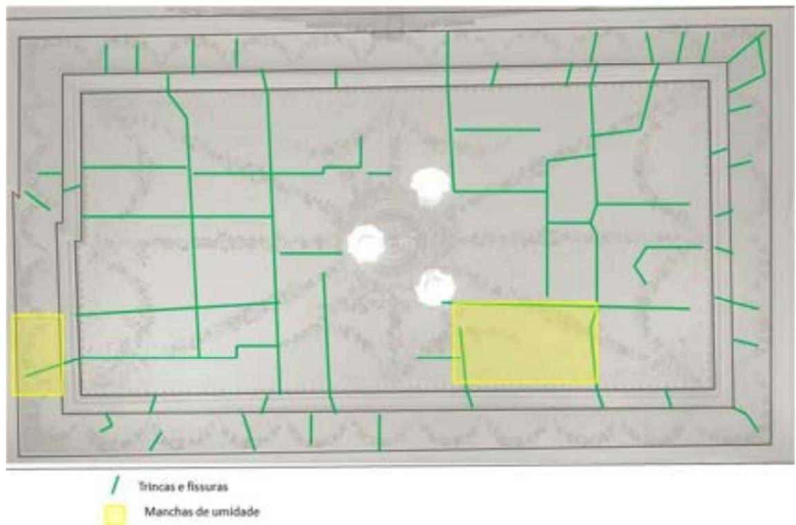
Figura 46: Forro lado do Evangelho. Mapeamento das trincas, fissuras e manchas de umidade.
